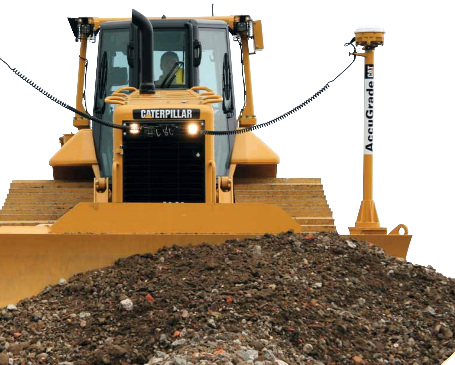
D6K LGP s duálním řízením GPS při svahování
