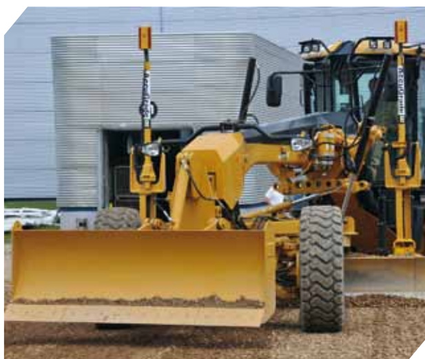
Grejdr Caterpillar 140M AWD s duálním laserovým řízením
