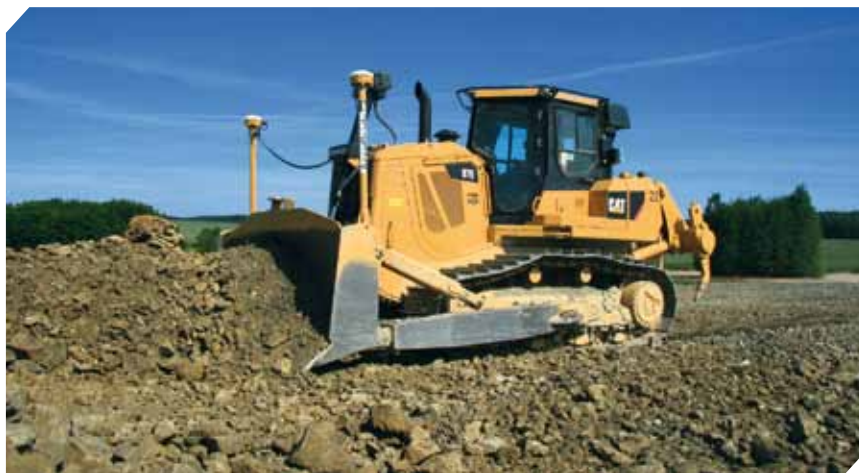
D7E XL s duálním řízením GPS při stavbě dálnice
