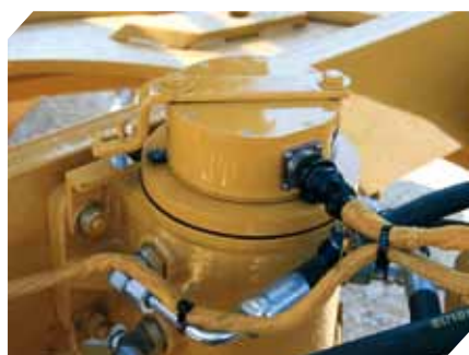
Senzor natočení radlice RS400
