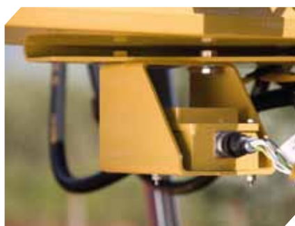
Senzor podélného sklonu stroje AS400
