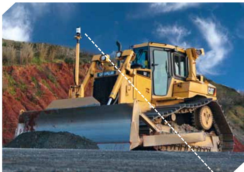
Caterpillar D6T LGP s řízením 3D-UTS
