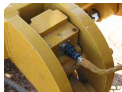
Senzor příčného sklonu radlice AS400
