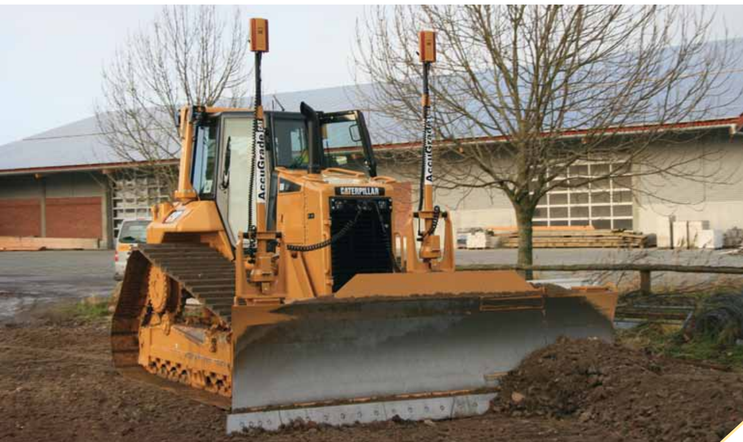
Caterpillar D6N LGP s duálním laserovým řízením
